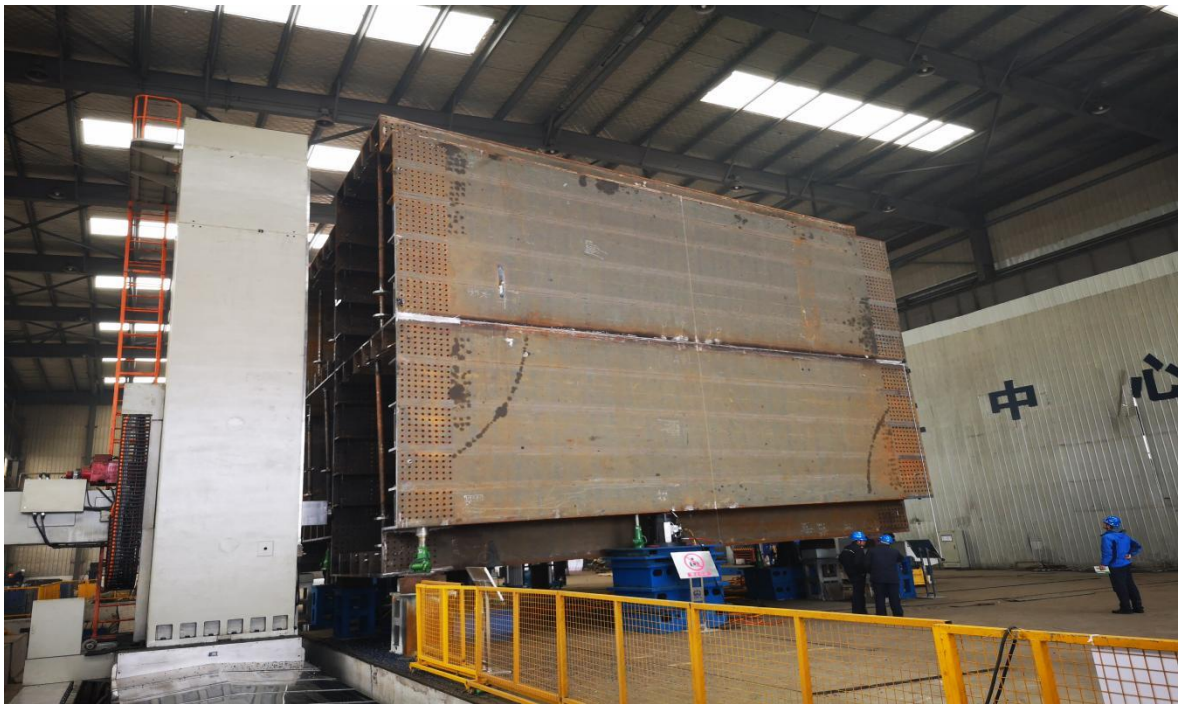
钢塔节段超大断面加工二次接刀
