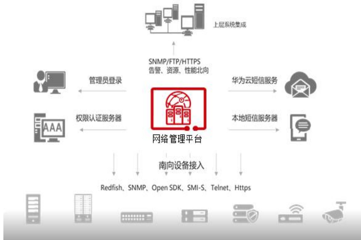
图 3.18 网管平台设备部署方式
