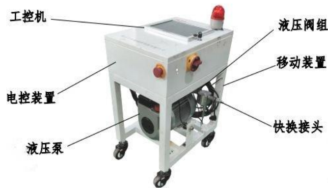
图 J-2 液压泵站
